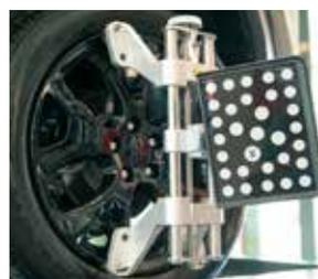
Veloci e facili da usare con design autocentrante, unghie a doppio profilo che consentono un fissaggio affidabile anche sui coprimozzo.
