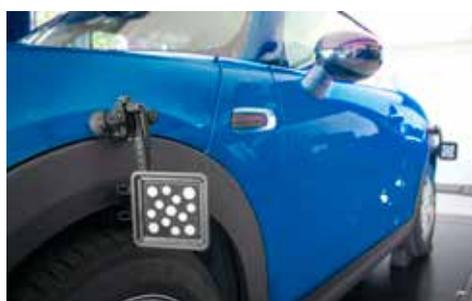
L'utilizzo dei bersagli opzionali per l'altezza scocca appositamente progettati consente di eliminare l'inserimento manuale dei dati, accelerare la misurazione e aumentare la precisione.
