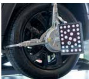
L'ancora si fissa al pneumatico con una forza di serraggio minima, senza toccare il cerchione, per un posizionamento rapido, sicuro e costante ogni volta.
